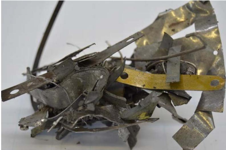
Abbildung 6: Bei der Sortierung der Eisenfraktion identifizierter "Knäuel"
