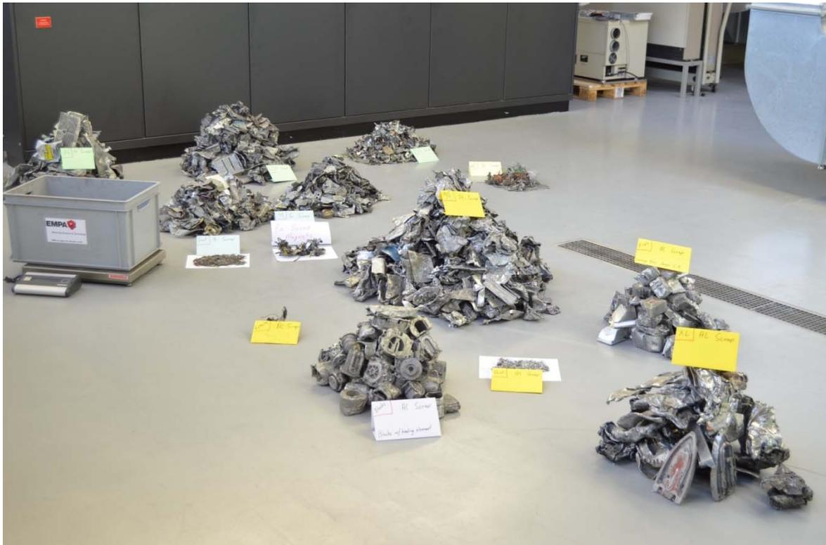
AI-3: Aussortierte Aluminium- und Eisenfraktionen für die Extraktionsversuche
